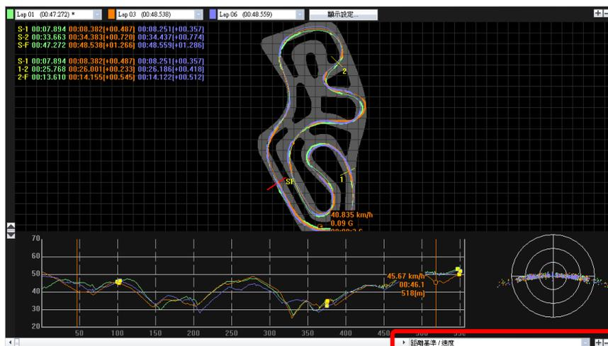
選擇時間基準，在多圈比較時可以顯示最高/最低速度差的曲線。
